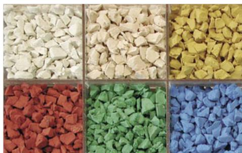
► Granulat. Le granulat est disponible en diverses couleurs et permet une coloration de toute l'épaisseur de la surface. Une légère altération peut survenir sous l'effet des rayons ultraviolets. Le granulat est ignifuge et peut au besoin être nettoyé à haute pression.
